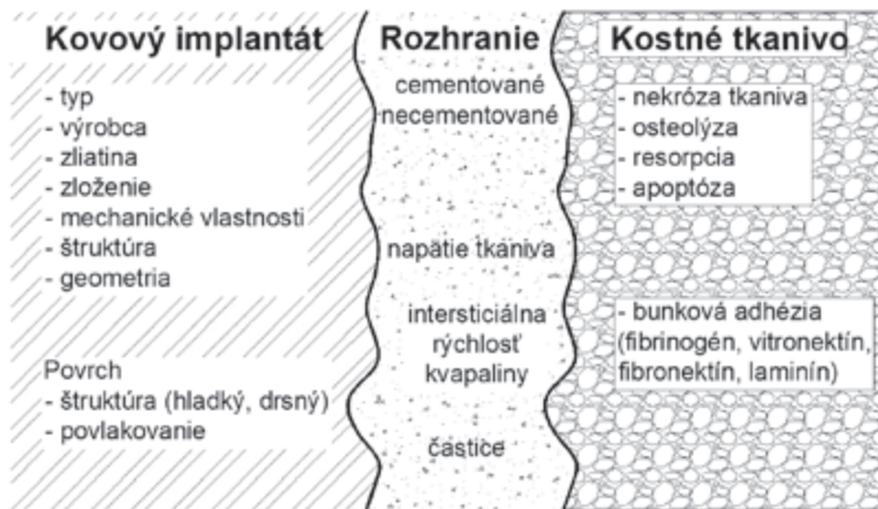
Obr. 1 Model rozhrania implantátu a kostného tkaniva kde, E_i = 200 \text{ GPa} , E_{cem} = 2,4 \text{ GPa} , E_{kosti} = 25 \text{ GPa}
