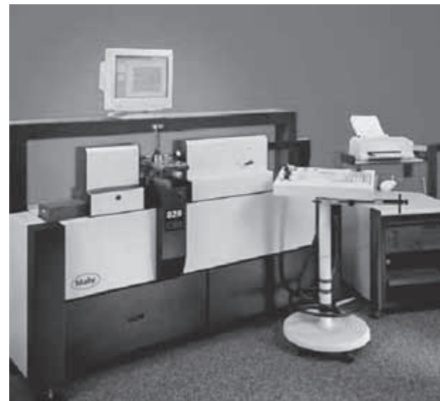
Obr. 2 Univerzální vodorovný délkoměr CiM 1000 (Mahr)
