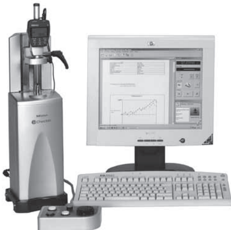
Obr. 1 Přístroj i-Checker pro kalibraci úchylkoměrů (Mitutoyo)
