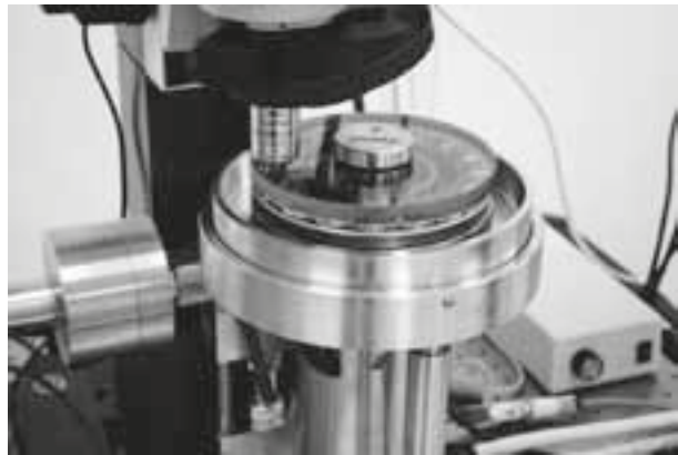
Obr. 6 Optický tribometr pro studium utváření mazacího filmu ve valivém ložisku
