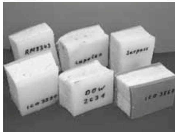
Obr. 7 Vzorky tvořené vnějšími vrstvami z modifikovaného PE materiálu vyplněné PUR pěnou
