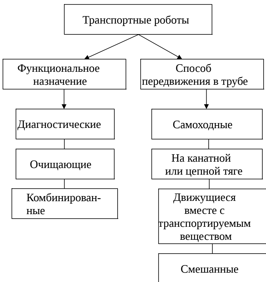
Рисунок 1 — Классификация транспортных роботов
