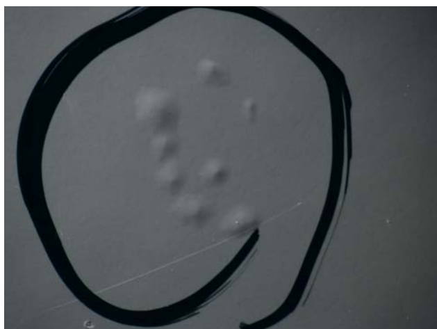
Obr. 10 Příklad korozního poškození povlaku práškové barvy aplikované na železnatý fosfát
