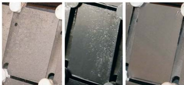
Obr. 2 Postupné odstranění zamaštění
